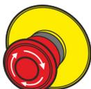
Durch Druck auf den NOT-HALT-Schalter wird die Maschine durch sofortiges Ausschalten der Energiezufuhr oder durch mechanische Trennung von den Antrieben stillgesetzt. Nachdem ein NOT-HALT-Schalter gedrückt wurde, muss dieser durch Drehen entriegelt werden, damit ein Wiedereinschalten möglich ist.
