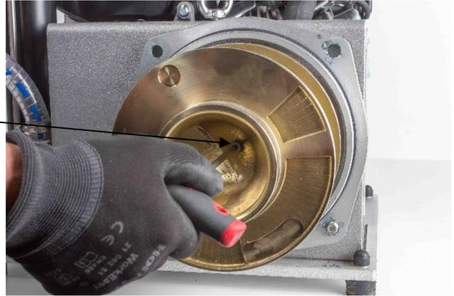
5. Setzen Sie das Spiralgehäuse über das montierte Laufrad auf den Motorflansch.
