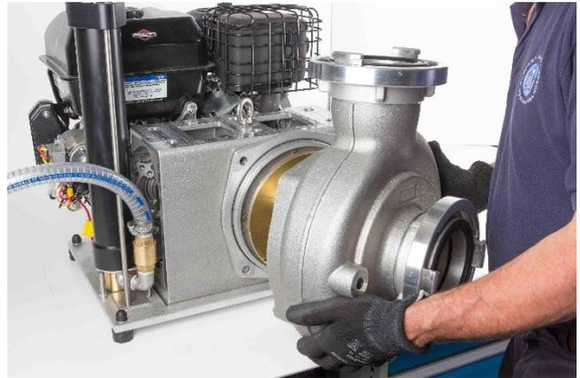
6. Schrauben Sie die vier Zylinderschrauben mit Innensechskant (M12), innerhalb des Lagerbockes, vom Motorflansch zum Spiralgehäuse, fest. (Auf dem Bild sind nur die beiden linken Schrauben dargestellt.)
