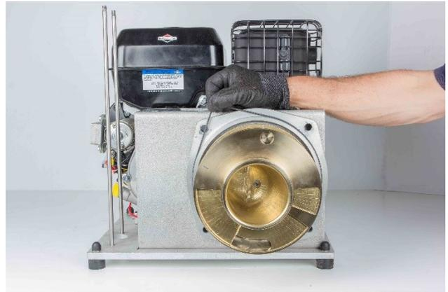
2. Setzen Sie die Ansaugpumpe in die Halterung ein.
