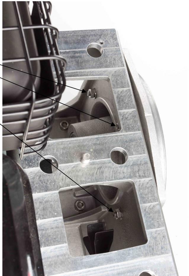
5. Demontieren Sie den Motorflansch vom Lagerbock. Verwenden Sie hierzu ggf. zwei Montageeisen.
