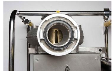
Lassen Sie an der Ablassschraube (siehe Bild) das restlich verbliebene Wasser im Spiralgehäuse ab. Drehen Sie die Ablassschraube dazu auf und warten bis kein Wasser mehr kommt und drehen sie wieder zu.
