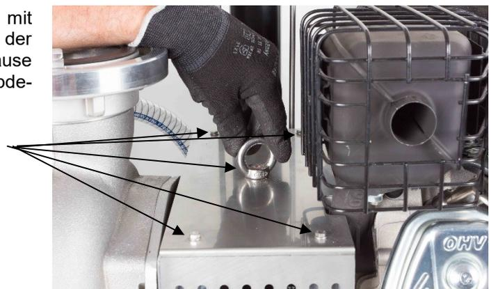
3. Entfernen Sie die vier Zylinderschrauben mit Innensechskant (M12) innerhalb des Lagerbockes vom Motorflansch zum Spiralgehäuse.
