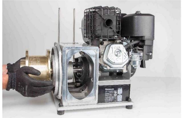
4. Nach mehrmaligem Drehen des Laufrades ist der Keilrippenriemen vollständig montiert.
