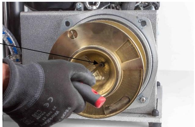
6. Demontieren Sie das Laufrad von der Welle. Verwenden Sie hierzu ggf. zwei Montageeisen.
